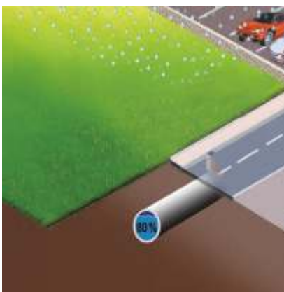
Obr. 1. Pôvodný stav: dažďové vody môžu voľne vsakovať do podlažia. Využitie stokových sietí je cca 80%.
